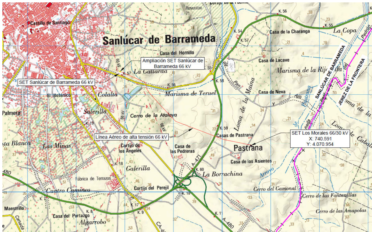
Ilustración 2. Localización línea evacuación LAAT 66 kV
