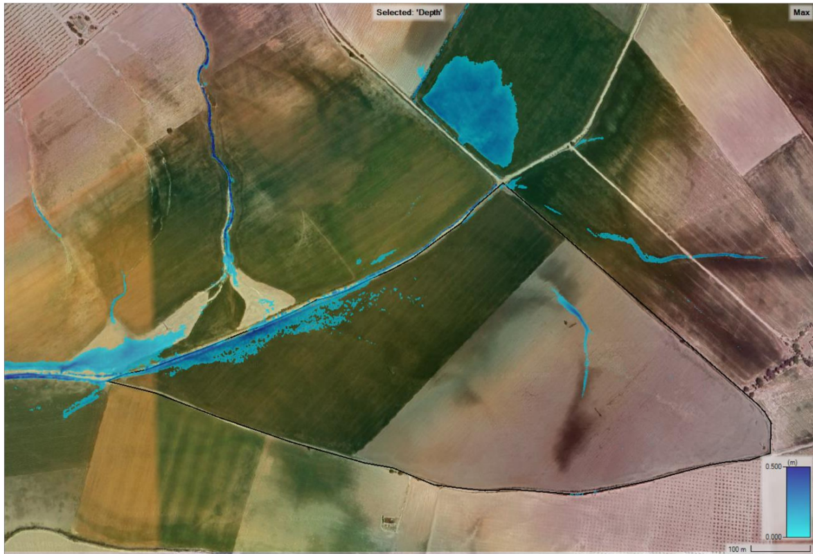
Ilustración 16-Línea de máxima inundación en análisis de riesgo de inundación (T=100 años)
